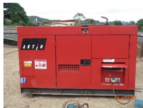
ภาพที่ 2.2-20 เครื่องจักรที่มีอุปกรณ์ลดความดังของเสียงที่แหล่งกำเนิด
